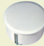
PP-F70 211 Puszka instalacyjna do ścian pustych, Ø70, głębokość: 40mm
