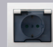
GPH-1WSP/00/d 1718 Gniazdo bryzgoszczelne z uziemieniem schuko, IP-44, z przesłonami torów prądowych
