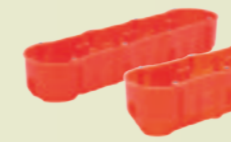
PP-F4x60PL-P/PP-F4x60GL-P Puszka instalacyjna, końcowa, poczwórna z wkrętami płytka 4xØ60, głębokość: 45mm/ głęboka 4xØ60, głębokość: 60mm
