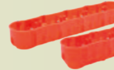
PP-F5x60PL-P/PP-F5x60GL-P Puszka instalacyjna końcowa, pięciokrotna z wkrętami płytka 5xØ60, głębokość: 45mm/ głęboka 5xØ60, głębokość: 60mm
