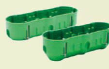
PP-F3x60PL.REG-N/PP-F3x60GL.REG-N Puszka instalacyjna, końcowa, potrójna z wkrętami, do ścian pustych płytka 3xØ60, głębokość: 45mm/ głęboka 3xØ60, głębokość: 60mm
